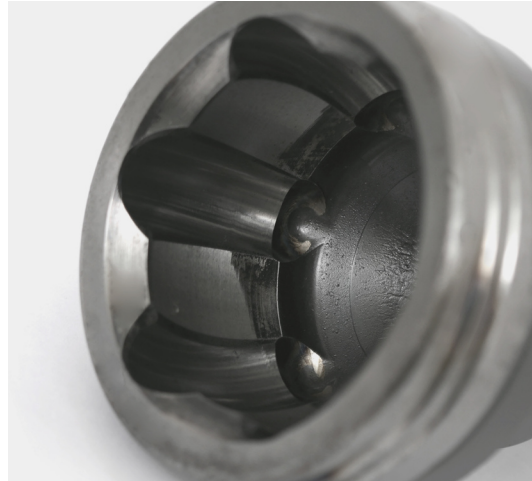
Gleichlaufgelenk: Außenring und Laufbahnen.
