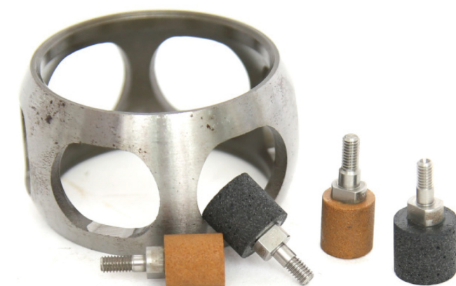
Käfigfenster-Bearbeitung: Bauteil und Werkzeugausführungen.
