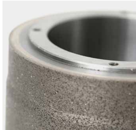
Detail der diamantbelegten Abrichtfläche.
