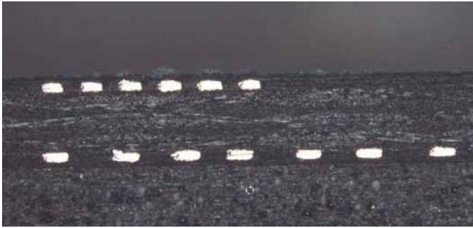
Schnittbild des seitenverstärkten Aufbaus.
